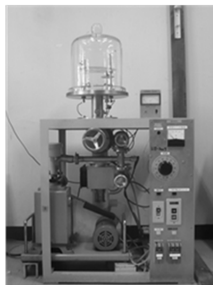
図 1 真空蒸着装置の外観
